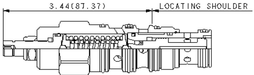
Les distributeurs en cartouches à action directe, à 3 voies (3 vers 4 passant et 2 bloqué) sont des dispositifs de commutation utilisés dans des circuits au débit modéré. Ils peuvent être utilisés tels quels ou pour activer des distributeurs pilotés ou des cartouches logiques de taille supérieure. La valve commute quand la différence de pression entre les chambres 1 et 4 dépasse le tarage.
