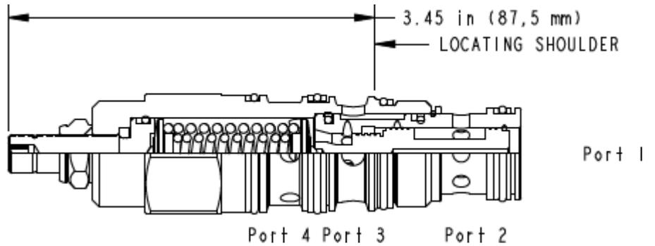
3/2-Wegeventil, direkt betätigt, in Ruhestellung Anschluss 3 mit 4 verbunden und Anschluss 2 verschlossen. Das Ventil kann den Ölstrom direkt steuern oder als Vorsteuerventil eine Hauptstufe betätigen. Es schaltet, sobald die Druckdifferenz zwischen Anschluss 1 und 4 größer ist als der Einstellwert.
