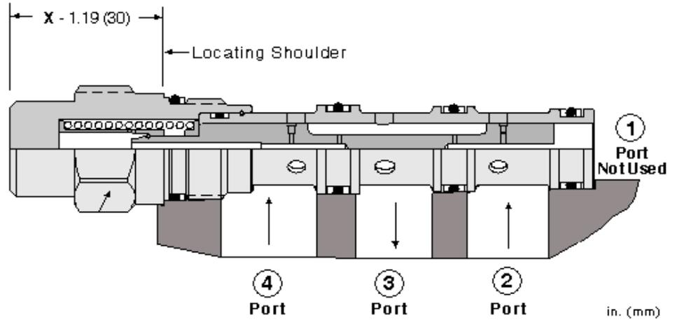
Les sélecteurs avec pilotage par la basse pression, permettent aux circuits hydrostatiques de se délester en huile chaude. Quand les 2 lignes du circuit (chambres 2 et 4) sont à la même pression, la valve est centrée par des ressorts dans une position où tous les orifices sont fermés. Quand l'une des lignes (chambre 2 ou 4) voit une pression plus élevée, la ligne opposée est connectée à l'orifice de délestage (chambre 3)
