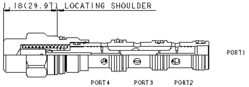
Spülventile eignen sich zum Ausspülen von heißem und ggf. verschmutztem Öl aus den geschlossenen Kreisläufen von hydrostatischen Antrieben. Wenn der Druck an den Anschlüssen 2 und 4 gleich ist, dann bleibt das Ventil in der federzentrierten, geschlossenen Mittelstellung. Bei Überschreitung eines Differenzdruckes zwischen den Anschlüssen 2 und 4 wird die Niederdruckseite mit dem Tank (Anschluss 3) verbunden.
