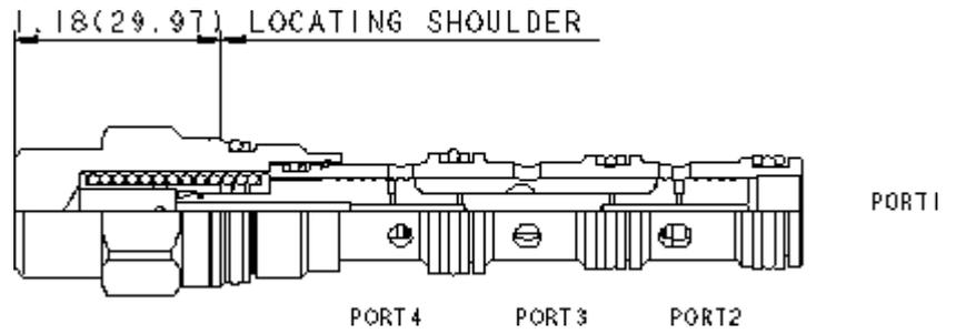
Les sélecteurs avec pilotage par la basse pression, permettent aux circuits hydrostatiques de se délester en huile chaude. Quand les 2 lignes du circuit (chambres 2 et 4) sont à la même pression, la valve est centrée par des ressorts dans une position où tous les orifices sont fermés. Quand l'une des lignes (chambre 2 ou 4) voit une pression plus élevée, la ligne opposée est connectée à l'orifice de délestage (chambre 3)
