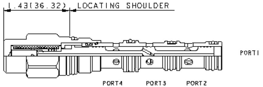
Spülventile eignen sich zum Ausspülen von heißem und ggf. verschmutztem Öl aus den geschlossenen Kreisläufen von hydrostatischen Antrieben. Wenn der Druck an den Anschlüssen 2 und 4 gleich ist, dann bleibt das Ventil in der federzentrierten, geschlossenen Mittelstellung. Bei Überschreitung eines Differenzdruckes zwischen den Anschlüssen 2 und 4 wird die Niederdruckseite mit dem Tank (Anschluss 3) verbunden.
