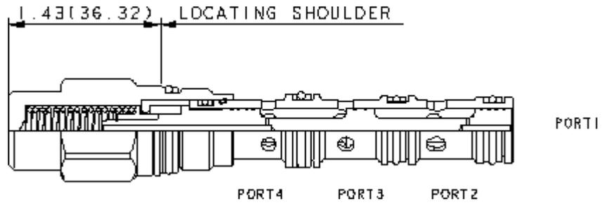
Wechselventile mit Federrückstellung sind 3/2-Wegeventile, bei denen in Ruhestellung Anschluss 4 mit Anschluss 3 verbunden und Anschluss 2 gesperrt ist. Durch Druckanstieg an Anschluss 2 über den Druck an Anschluss 4 wird Anschluss 2 mit Anschluss 3 verbunden und Anschluss 4 ist gesperrt.
