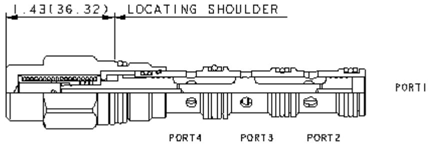
3/3-Wechsel-Wegeventile finden hauptsächlich in Eilgangschaltungen Verwendung. Wenn der Druck an den Anschlüssen 2 und 4 gleich ist, dann bleibt das Ventil in der federzentrierten, geschlossenen Mittelstellung. Bei Überschreitung eines Differenzdruckes zwischen den Anschlüssen 2 und 4 wird die Hochdruckseite mit dem Anschluss 3 verbunden.
