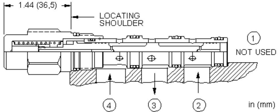
Les sélecteurs avec pilotage par la haute pression sont le plus souvent utilisés dans les circuits différentiels permanents. Quand les deux lignes du circuit (chambres 2 et 4) sont à la même pression, la valve est centrée par des ressorts dans une position où tous les orifices sont bloqués. Quand l'une des lignes (chambre 2 ou 4) voit une pression plus élevée, elle est connectée à l'orifice commun (chambre 3).
