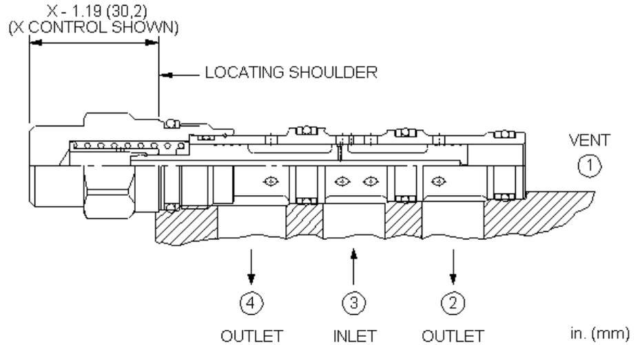
Durch Druckentlastung schaltbares 3/2-Wegeventil, in Ruhestellung geschlossen. Durch Steuerdruckentlastung an Anschluss 1 entsteht ein Differenzdruck zwischen Anschluss 3 und 1, der das Ventil gegen die Federkraft betätigt und dadurch Anschluss 3 mit 2 und 4 verbindet.
