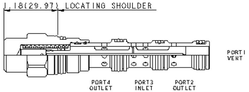
Ce déviateur qui commute quand on libère le drain, est une cartouche à 3 voies et 2 positions qui est normalement fermée. Quand on draine l'orifice 1 la pression différentielle entre l'orifice 3 et l'orifice 1 dépasse la force du ressort entraînant la commutation de la valve et de ce fait une connexion de l'orifice 3 avec les orifices 2 et 4.
