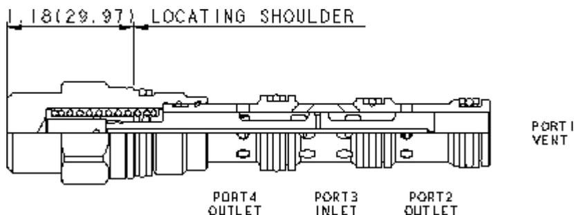
Ce déviateur qui commute quand on libère le drain, est une cartouche à 3 voies et 2 positions qui est normalement passante de la chambre 3 vers la 4. Quand on draine l'orifice 1 la pression différentielle entre l'orifice 3 et l'orifice 1 dépasse la force du ressort, entraînant la commutation de la valve et de ce fait une connexion de l'orifice 3 à l'orifice 2.
