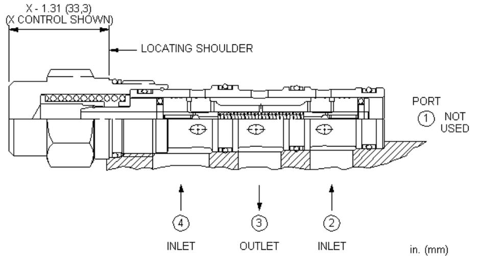
Spülventile eignen sich für den Ablass von heißem Öl aus geschlossenen Kreisen. Wenn der Druck an den Anschlüssen 2 und 4 gleich ist, dann bleibt das Ventil in der federzentrierten, geschlossenen Mittelstellung. Bei Überschreitung eines Differenzdruckes zwischen den Anschlüssen 2 und 4 wird die Niederdruckseite mit dem Tank (Anschluss 3) verbunden. Das verzögert schaltende Wechselventil verhindert Volumenstromspitzen auf der Ablaufseite von Spülventilschaltungen.
