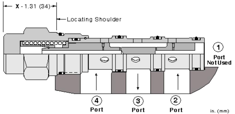
Spülventile eignen sich zum Ausspülen von heißem und ggf. verschmutztem Öl aus den geschlossenen Kreisläufen von hydrostatischen Antrieben. Wenn der Druck an den Anschlüssen 2 und 4 gleich ist, dann bleibt das Ventil in der federzentrierten, geschlossenen Mittelstellung. Bei Überschreitung eines Differenzdruckes zwischen den Anschlüssen 2 und 4 wird die Niederdruckseite mit dem Tank (Anschluss 3) verbunden.
