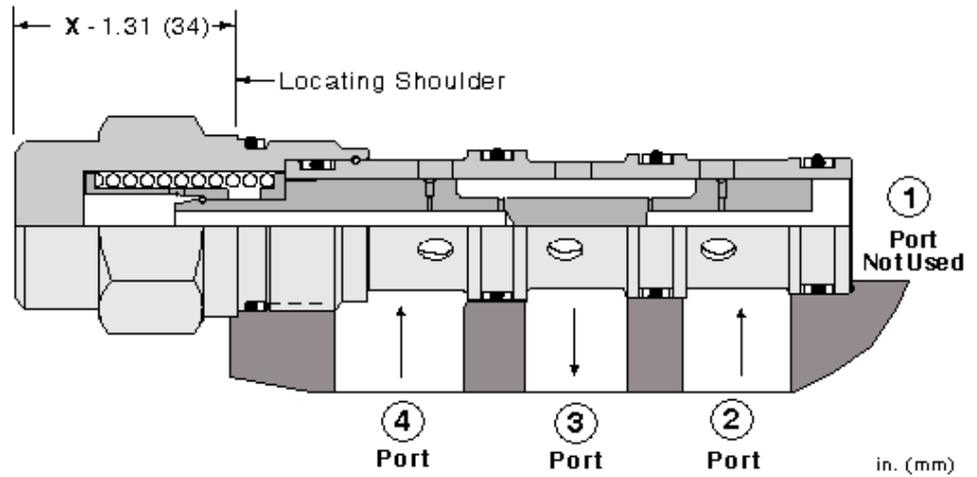
Les sélecteurs avec pilotage par la basse pression, permettent aux circuits hydrostatiques de se délester en huile chaude. Quand les 2 lignes du circuit (chambres 2 et 4) sont à la même pression, la valve est centrée par des ressorts dans une position où tous les orifices sont fermés. Quand l'une des lignes (chambre 2 ou 4) voit une pression plus élevée, la ligne opposée est connectée à l'orifice de délestage (chambre 3)
