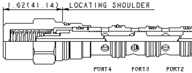
Les sélecteurs à rappel latéral par ressort, avec pilotage par la haute pression sont des valves à 2 positions qui au repos relient la ligne de pression 4 à l'orifice commun (chambre 3) et bloquent la ligne 2. Quand la pression sur la ligne 2 dépasse la pression de la ligne 4, le tiroir commute pour relier 2 à l'orifice commun et la ligne 4 est alors bloquée.
