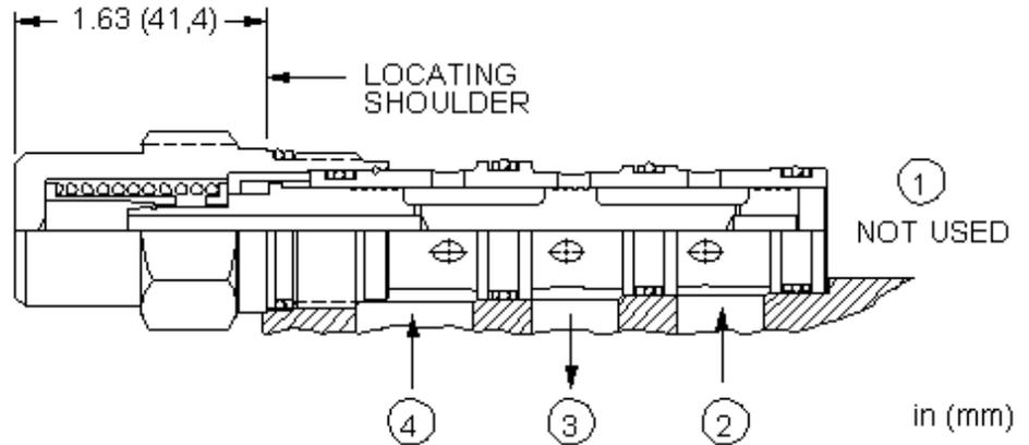
Les sélecteurs avec pilotage par la haute pression sont le plus souvent utilisés dans les circuits différentiels permanents. Quand les deux lignes du circuit (chambres 2 et 4) sont à la même pression, la valve est centrée par des ressorts dans une position où tous les orifices sont bloqués. Quand l'une des lignes (chambre 2 ou 4) voit une pression plus élevée, elle est connectée à l'orifice commun (chambre 3).
