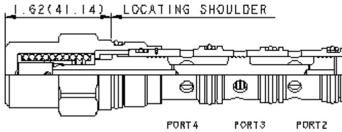
3/3-Wechsel-Wegeventile finden hauptsächlich in Eilgangschaltungen Verwendung. Wenn der Druck an den Anschlüssen 2 und 4 gleich ist, dann bleibt das Ventil in der federzentrierten, geschlossenen Mittelstellung. Bei Überschreitung eines Differenzdruckes zwischen den Anschlüssen 2 und 4 wird die Hochdruckseite mit dem Anschluss 3 verbunden.
