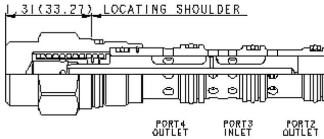
Durch Druckentlastung schaltbares 3/2-Wegeventil, in Ruhestellung geschlossen. Durch Steuerdruckentlastung an Anschluss 1 entsteht ein Differenzdruck zwischen Anschluss 3 und 1, der das Ventil gegen die Federkraft betätigt und dadurch Anschluss 3 mit 2 und 4 verbindet.
