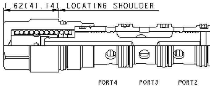
Les sélecteurs avec pilotage par la basse pression, permettent aux circuits hydrostatiques de se délester en huile chaude. Quand les 2 lignes du circuit (chambres 2 et 4) sont à la même pression, la valve est centrée par des ressorts dans une position où tous les orifices sont fermés. Quand l'une des lignes (chambre 2 ou 4) voit une pression plus élevée, la ligne opposée est connectée à l'orifice de délestage (chambre 3)
