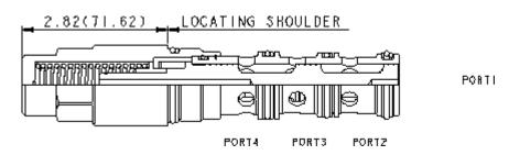
Wechselventile mit Federrückstellung sind 3/2-Wegeventile, bei denen in Ruhestellung Anschluss 4 mit Anschluss 3 verbunden und Anschluss 2 gesperrt ist. Durch Druckanstieg an Anschluss 2 über den Druck an Anschluss 4 wird Anschluss 2 mit Anschluss 3 verbunden
