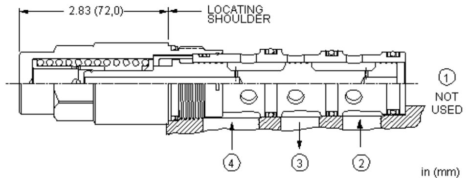
Les sélecteurs avec pilotage par la haute pression sont le plus souvent utilisés dans les circuits différentiels permanents. Quand les deux lignes du circuit (chambres 2 et 4) sont à la même pression, la valve est centrée par des ressorts dans une position où tous les orifices sont bloqués. Quand l'une des lignes (chambre 2 ou 4) voit une pression plus élevée, elle est connectée à l'orifice commun (chambre 3).
