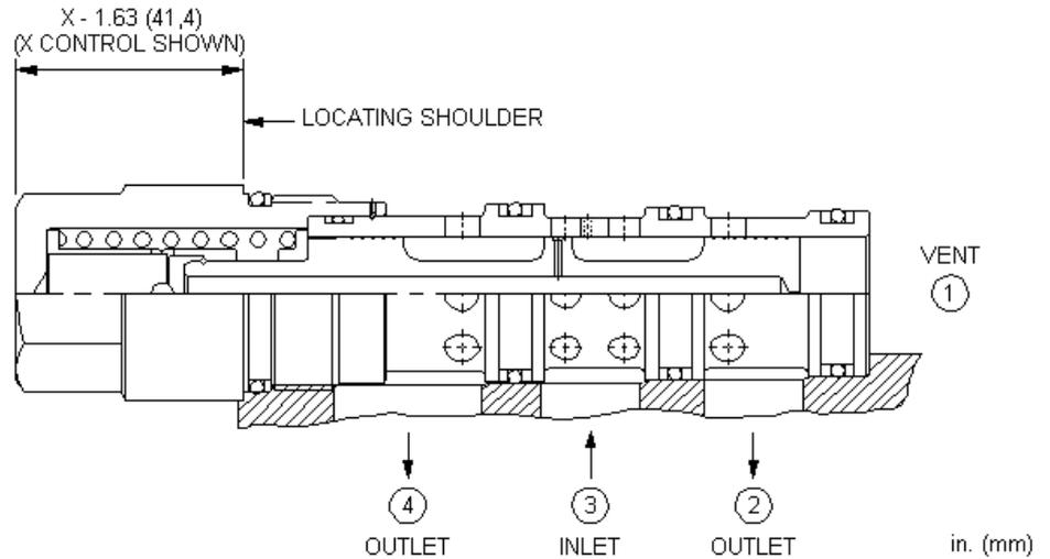
Durch Druckentlastung schaltbares 3/2-Wegeventil, in Ruhestellung geschlossen. Durch Steuerdruckentlastung an Anschluss 1 entsteht ein Differenzdruck zwischen Anschluss 3 und 1, der das Ventil gegen die Federkraft betätigt und dadurch Anschluss 3 mit 2 und 4 verbindet.
