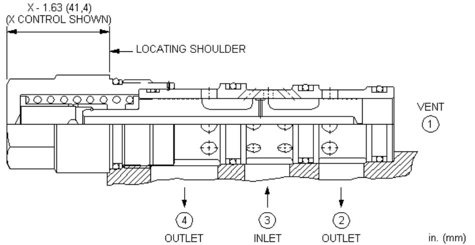
Durch Druckentlastung schaltbares 3/2-Wegeventil, in Ruhestellung von Anschluss 3 nach 4 geöffnet. Durch Steuerdruckentlastung an Anschluss 1 entsteht ein Differenzdruck zwischen Anschluss 3 und 1, der das Ventil gegen die Federkraft betätigt und dadurch Anschluss 3 mit 2 verbindet.
