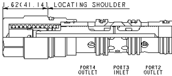
Ce déviateur qui commute quand on libère le drain, est une cartouche à 3 voies et 2 positions qui est normalement passante de la chambre 3 vers la 4. Quand on draine l'orifice 1 la pression différentielle entre l'orifice 3 et l'orifice 1 dépasse la force du ressort, entraînant la commutation de la valve et de ce fait une connexion de l'orifice 3 à l'orifice 2.
