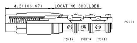
Les sélecteurs à rappel latéral par ressort, avec pilotage par la haute pression sont des valves à 2 positions qui au repos relient la ligne de pression 4 à l'orifice commun (chambre 3) et bloquent la ligne 2. Quand la pression sur la ligne 2 dépasse la pression de la ligne 4, le tiroir commute pour relier 2 à l'orifice commun et la ligne 4 est alors bloquée.
