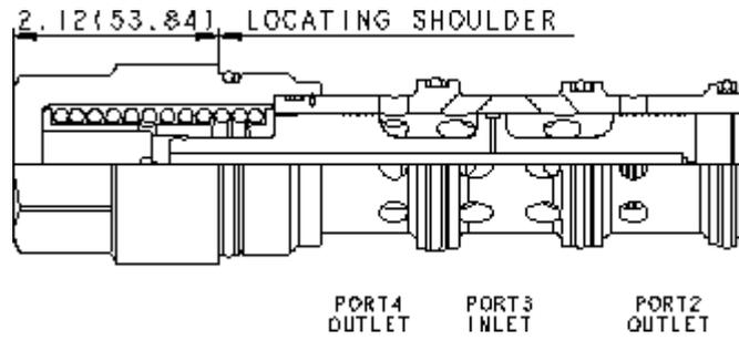
Durch Druckentlastung schaltbares 3/2-Wegeventil, in Ruhestellung von Anschluss 3 nach 4 geöffnet. Durch Steuerdruckentlastung an Anschluss 1 entsteht ein Differenzdruck zwischen Anschluss 3 und 1, der das Ventil gegen die Federkraft betätigt und dadurch Anschluss 3 mit 2 verbindet.
