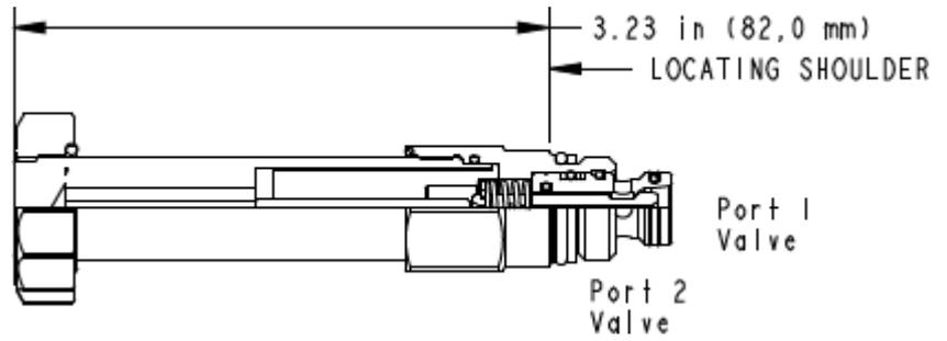
Das magnetbetätigte 2/2-Wegeventil aus der FLeX Serie ist ein direktgesteuertes Sitzventil. Das Ventil ist in offener oder geschlossener Ruhestellung erhältlich, der Kolben ist druckausgeglichen, die Leckage ist gering und es sperrt in beiden Richtungen. Das Ventil kann direkt in eine Bohrung an SUNs vorgesteuerten und entlastbaren Hauptstufenventilen montiert werden um eine integrierte Vorsteuerung zu realisieren.
