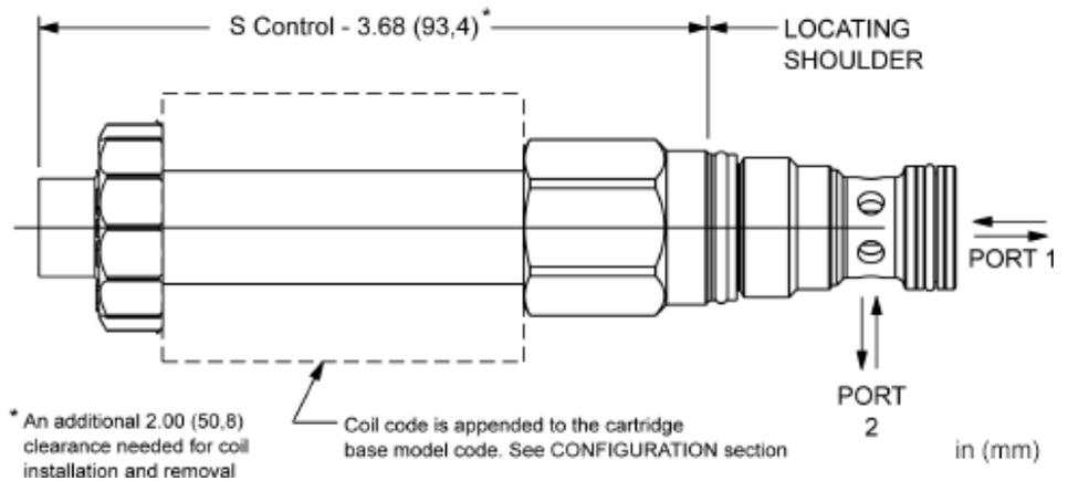
Diese magnetbetätigten 2/2-Wege-Ventile sind direkt wirkende Sitzventile mit Soft-Shift-Funktion. Mit Hilfe der Soft-Shift-Funktion können Druckstöße infolge der Ventilbetätigung reduziert werden. Die Ventile sind mit geschlossener und geöffneter Ruhestellung erhältlich. Die Ventile werden mit Spulen der Serien 740 und 747 betrieben.
