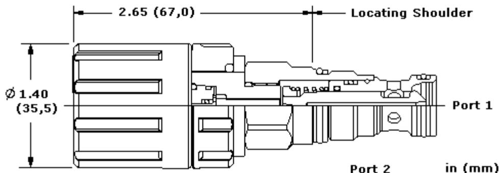
Dieses handbetätigte 2/2-Wegeventil ist ein direkt gesteuertes Sitzventil, welches genutzt wird, um die Richtung von Volumenströmen in hydraulischen Schaltungen zu bestimmen. Das Ventil wird in unbetätigt offener und geschlossener Ausführung angeboten. Wegen der Sitzbauweise ist das Ventil für Lasthalteanwendungen geeignet. Die Handbetätigung erfolgt über SUNs dreh- und rastbare Verstelleinrichtung. Diese Verstellung ist nicht für den Dauerbetrieb geeignet.
