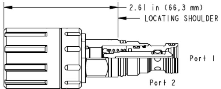
Dieses handbetätigte 2/2-Wegeventil ist ein direkt gesteuertes Sitzventil, welches genutzt wird, um die Richtung von Volumenströmen in hydraulischen Schaltungen zu bestimmen. Das Ventil wird in unbetätigt offener und geschlossener Ausführung angeboten. Wegen der Sitzbauweise ist das Ventil für Lasthalteanwendungen geeignet. Die Handbetätigung erfolgt über SUNs dreh- und rastbare Verstelleinrichtung. Diese Verstellung ist nicht für den Dauerbetrieb geeignet.
