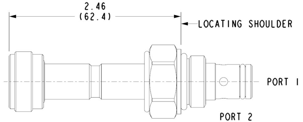
Das magnetbetätigte 2/2-Wegeventil ist ein direkt gesteuertes druckausgeglichenes Sitzventil.
