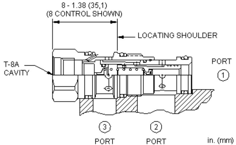
2/2-Wegeventil mit geöffneter Ausgangsstellung, für T-8A Vorsteuerventil. Das Ventil kann den Ölstrom direkt steuern oder als Vorsteuerventil eine Hauptstufe betätigen, es schaltet, sobald Steueröl durch das in die T-8A Einschraubbohrung eingebaute Pilotventil fließt.
