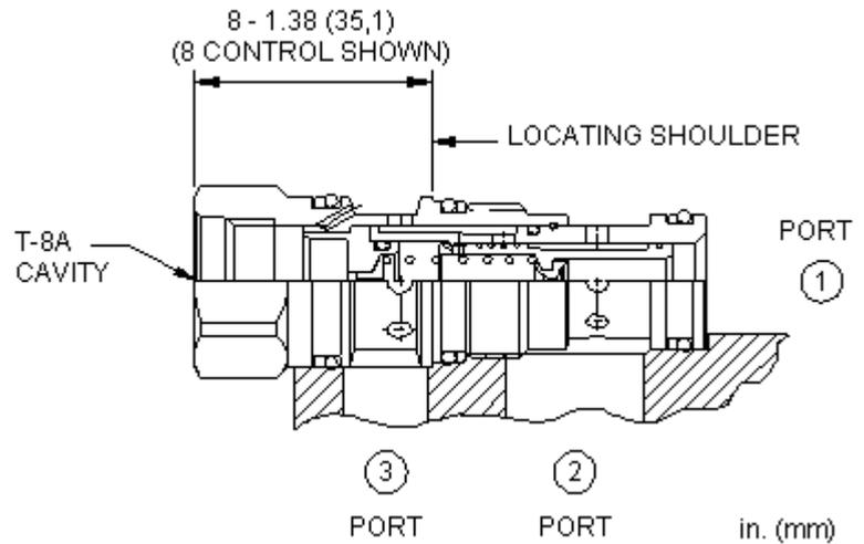
Ce distributeur en cartouche est une cartouche directionnelle normalement fermée à 2 voies qui intègre une cavité destinée à une valve de pilotage. Elle peut être utilisée telle quelle ou pour activer des distributeurs pilotés ou des cartouches logiques de taille supérieure. La valve commute quand le débit est passant dans la valve de pilotage installée dans sa cavité T-8A.
