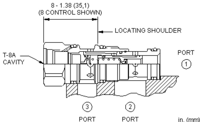
3/2-Wegeventil, in Ruhestellung Anschluss 1 verschlossen, 2 mit 3 verbunden, für T-8A Vorsteuerventil. Das Ventil kann den Ölstrom direkt steuern oder als Vorsteuerventil eine Hauptstufe betätigen. Es schaltet, sobald Steueröl durch das in die T-8A Einschraubbohrung eingebaute Pilotventil fließt.
