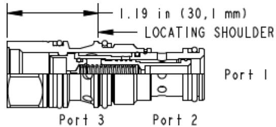
Ce distributeur en cartouche à 3 voies (1 vers 2 passant et 3 bloqué) intègre une cavité destinée à une valve de pilotage. Elle peut être utilisée telle quelle ou pour activer des distributeurs pilotés ou des cartouches logiques de taille supérieure. La valve commute quand le débit est passant dans la valve de pilotage installée dans sa cavité T-8A.
