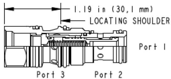
Ce distributeur en cartouche à 3 voies (1 vers 2 passant et 3 bloqué) intègre une cavité destinée à une valve de pilotage. Elle peut être utilisée telle quelle ou pour activer des distributeurs pilotés ou des cartouches logiques de taille supérieure. La valve commute quand le débit est passant dans la valve de pilotage installée dans sa cavité T-8A.
