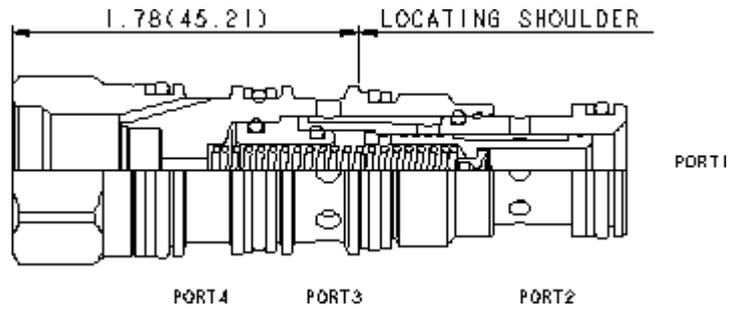
Ce distributeur en cartouche est une cartouche directionnelle normalement fermée à 2 voies qui intègre une cavité destinée à une valve de pilotage. Elle peut être utilisée telle quelle ou pour activer des distributeurs pilotés ou des cartouches logiques de taille supérieure. La valve commute quand le débit est passant dans la valve de pilotage installée dans sa cavité T-8A.
