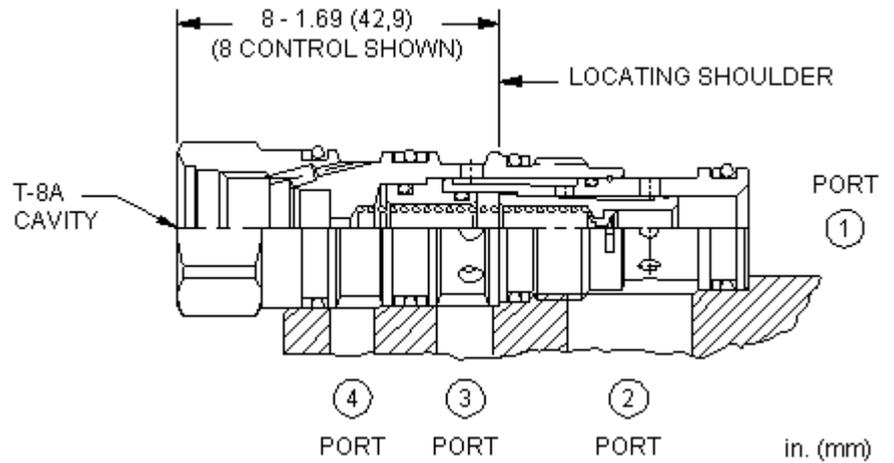
3/2-Wegeventil, in Ruhestellung Anschluss 1 verschlossen, 2 mit 3 verbunden, für T-8A Vorsteuerventil. Das Ventil kann den Ölstrom direkt steuern oder als Vorsteuerventil eine Hauptstufe betätigen. Es schaltet, sobald Steueröl durch das in die T-8A Einschraubbohrung eingebaute Pilotventil fließt.
