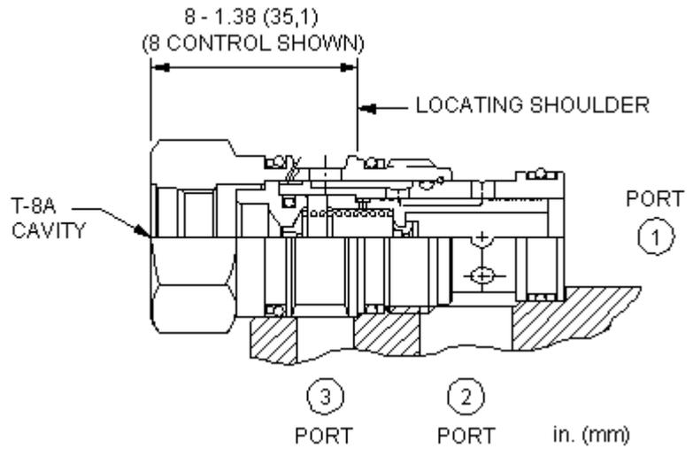
2/2-Wegeventil mit geöffneter Ausgangsstellung, für T-8A Vorsteuerventil. Das Ventil kann den Ölstrom direkt steuern oder als Vorsteuerventil eine Hauptstufe betätigen, es schaltet, sobald Steueröl durch das in die T-8A Einschraubbohrung eingebaute Pilotventil fließt.
