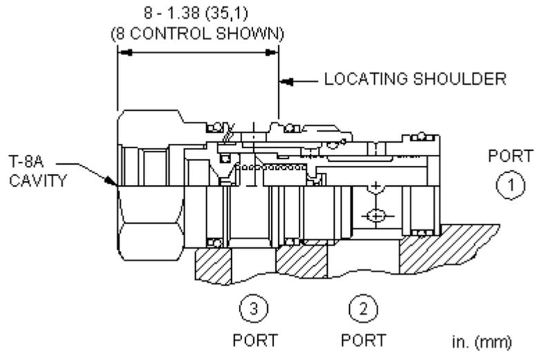
2/2-Wegeventil mit geschlossener Ausgangsstellung, für T-8A Vorsteuerventil. Das Ventil kann den Ölstrom direkt steuern oder als Vorsteuerventil eine Hauptstufe betätigen. Es schaltet, sobald Steueröl durch das in die T-8A Einschraubbohrung eingebaute Pilotventil fließt.
