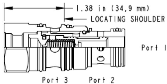
Ce distributeur en cartouche à 3 voies (1 bloqué et 2 vers 3 passant) intègre une cavité destinée à une valve de pilotage. Elle peut être utilisée telle quelle ou pour activer des distributeurs pilotés ou des cartouches logiques de taille supérieure. La valve commute quand le débit est passant dans la valve de pilotage installée dans sa cavité T-8A.
