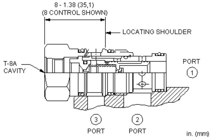
3/2-Wegeventil, in Ruhestellung Anschluss 1 verschlossen, 2 mit 3 verbunden, für T-8A Vorsteuerventil. Das Ventil kann den Ölstrom direkt steuern oder als Vorsteuerventil eine Hauptstufe betätigen. Es schaltet, sobald Steueröl durch das in die T-8A Einschraubbohrung eingebaute Pilotventil fließt.
