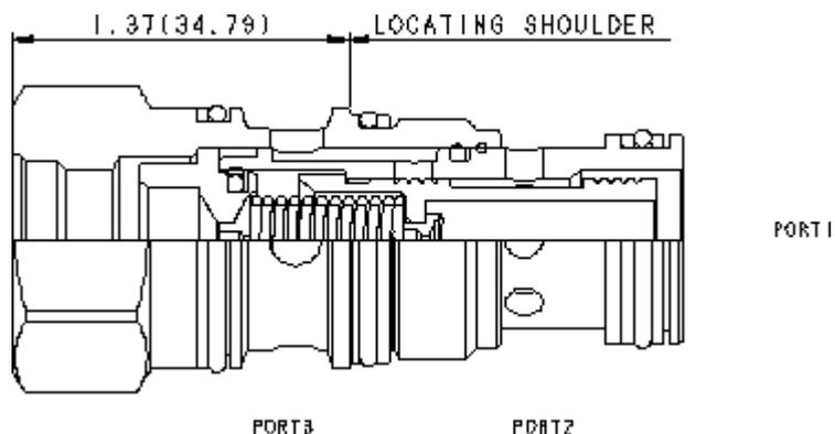
Ce distributeur en cartouche à 3 voies (1 vers 2 passant et 3 bloqué) intègre une cavité destinée à une valve de pilotage. Elle peut être utilisée telle quelle ou pour activer des distributeurs pilotés ou des cartouches logiques de taille supérieure. La valve commute quand le débit est passant dans la valve de pilotage installée dans sa cavité T-8A.
