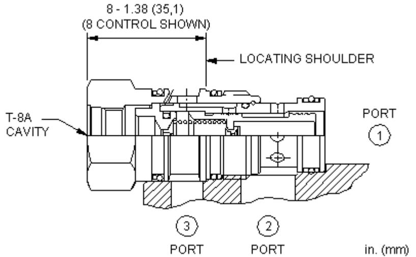
3/2-Wegeventil, in Ruhestellung Anschluss 1 mit 2 verbunden und Anschluss 3 verschlossen, für T-8A Vorsteuerventil. Das Ventil kann den Ölstrom direkt steuern oder als Vorsteuerventil eine Hauptstufe betätigen. Es schaltet, sobald Steueröl durch das in die T-8A Einschraubventilbohrung eingebaute Pilotventil fließt.
