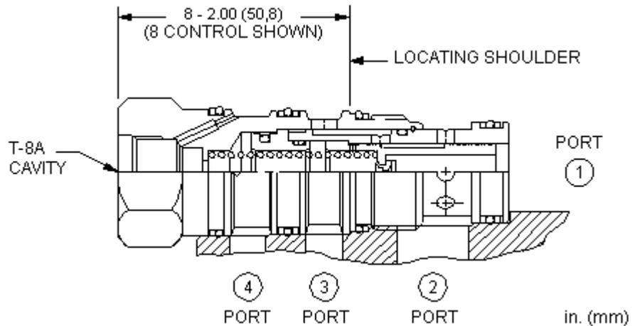
2/2-Wegeventil mit geöffneter Ausgangsstellung, für T-8A Vorsteuerventil. Das Ventil kann den Ölstrom direkt steuern oder als Vorsteuerventil eine Hauptstufe betätigen, es schaltet, sobald Steueröl durch das in die T-8A Einschraubbohrung eingebaute Pilotventil fließt.
