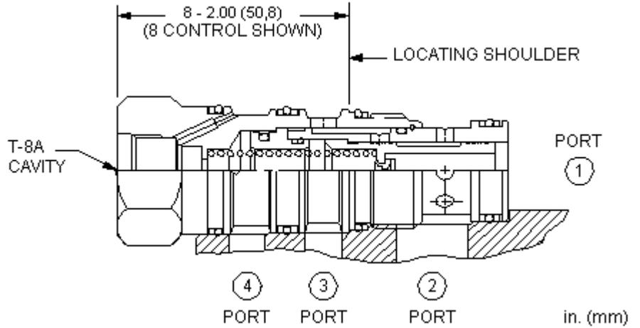
2/2-Wegeventil mit geschlossener Ausgangsstellung, für T-8A Vorsteuerventil. Das Ventil kann den Ölstrom direkt steuern oder als Vorsteuerventil eine Hauptstufe betätigen. Es schaltet, sobald Steueröl durch das in die T-8A Einschraubbohrung eingebaute Pilotventil fließt.
