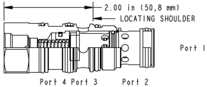
Ce distributeur en cartouche à 3 voies (1 vers 2 passant et 3 bloqué) intègre une cavité destinée à une valve de pilotage. Elle peut être utilisée telle quelle ou pour activer des distributeurs pilotés ou des cartouches logiques de taille supérieure. La valve commute quand le débit est passant dans la valve de pilotage installée dans sa cavité T-8A.
