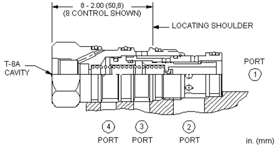
3/2-Wegeventil, in Ruhestellung Anschluss 1 mit 2 verbunden und Anschluss 3 verschlossen, für T-8A Vorsteuerventil. Das Ventil kann den Ölstrom direkt steuern oder als Vorsteuerventil eine Hauptstufe betätigen. Es schaltet, sobald Steueröl durch das in die T-8A Einschraubventilbohrung eingebaute Pilotventil fließt.
