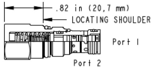
Die druckkompensierten Stromregelventile mit fester Blende und Umgehungs-rückschlagventil bieten eine präzise Volumenstromregelung. Die Ventile können, auch bei großen Druckschwankungen, zur Zu- oder Ablaufregelung genutzt werden. Das integrierte Umgehungs-rückschlagventil mit hoher Kapazität ermöglicht einen Durchfluss von Anschluss 2 nach Anschluss 1. Der gewünschte Volumenstrom wird vom Benutzer angegeben und wird im Werk eingestellt.
